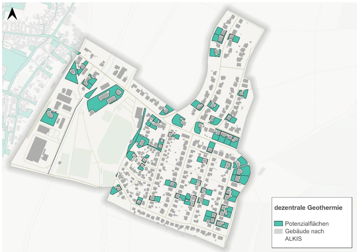
Abbildung 58 Potenzialflächen für Erdkollektoren in Echzell Wohngebiet
