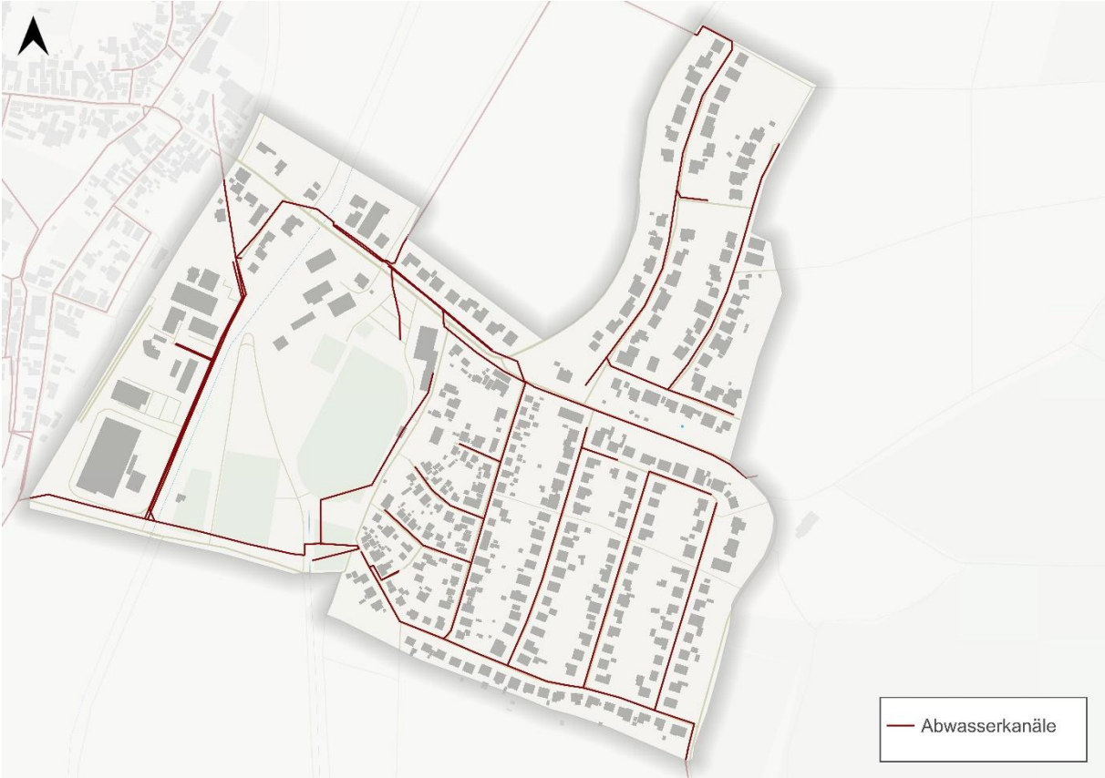
Abbildung 23 Kanäle für Abwasser in Echzell Wohngebiet
