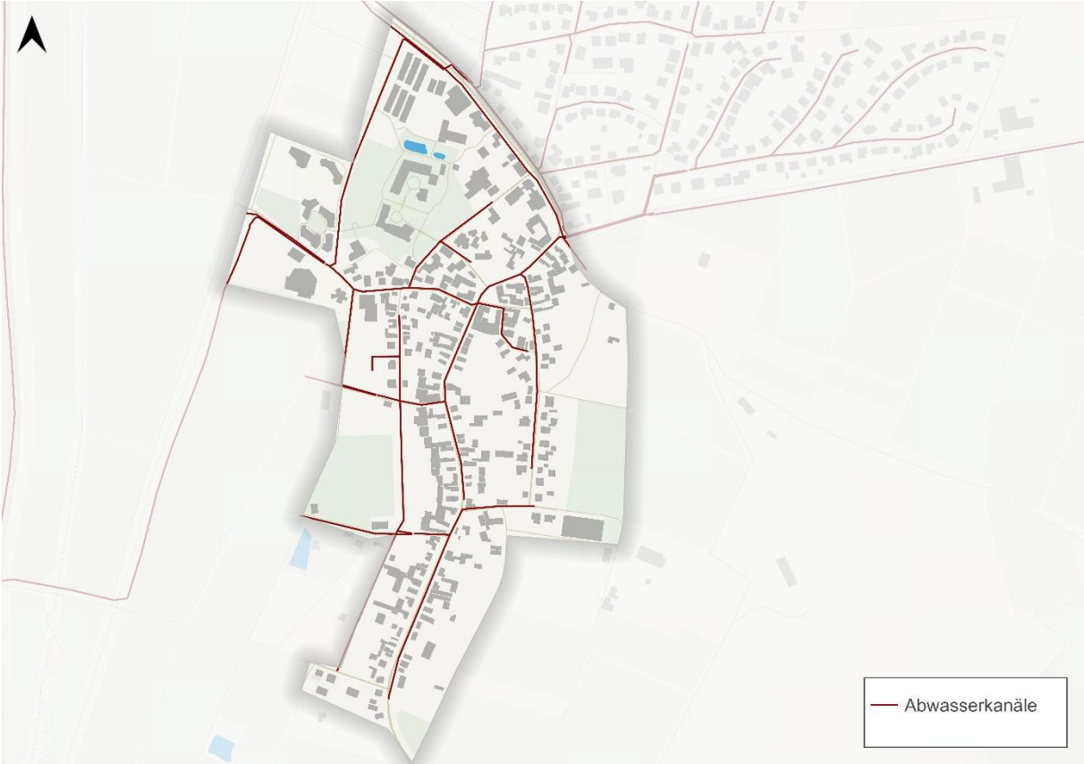
Abbildung 26 Kanäle für Abwasser in Bingenheim Süd
