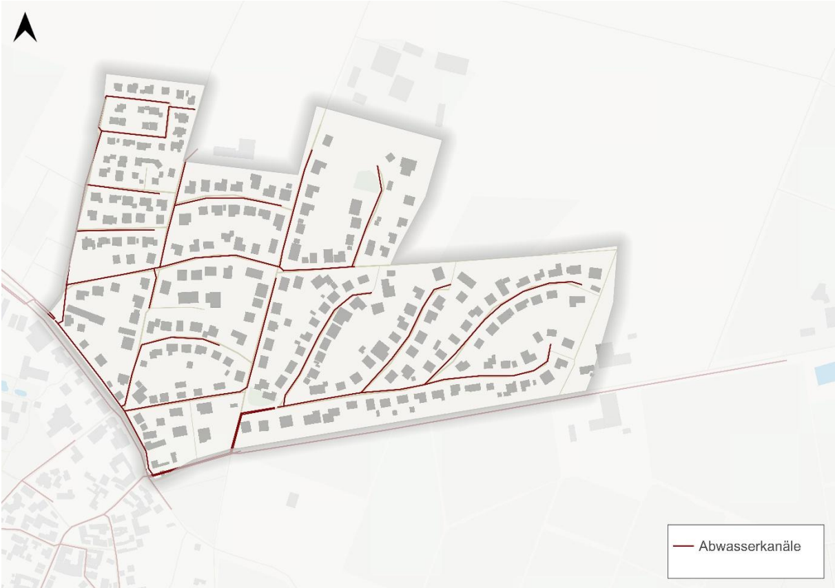
Abbildung 24 Kanäle für Abwasser in Bingenheim Nord
